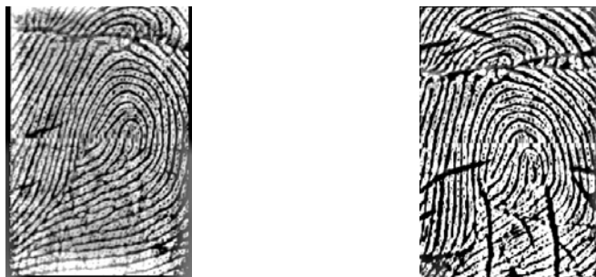
Рис.5. Изображения отпечатка одного пальца, полученные на одном сканере с разницей во времени 5 лет.
